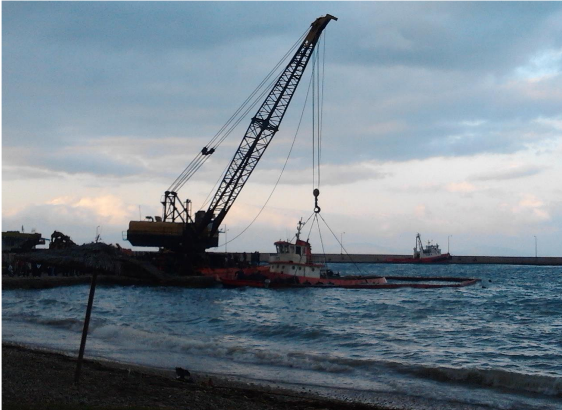
Εικόνα 5: Ανέλκυση του Ρ/Κ «ARTEMIS V» στο λιμένα Κιάτου, από πλωτό γερανό.
