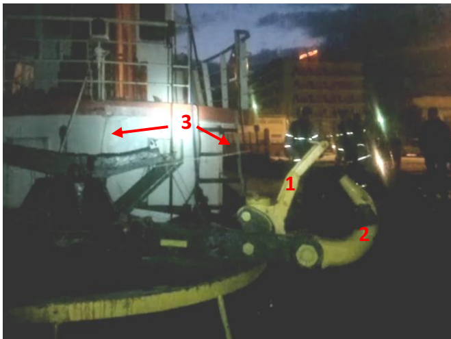
Εικόνα 8: Η διάταξη άμεσης απελευθέρωσης του άγκιστρου ρυμούλκησης του Ρ/Κ «ΑΡΤΕΜΙΣ V». Έχει αποτυπωθεί η κατάσταση πριν (αριστερά) και μετά (δεξιά) την απελευθέρωση. Διακρίνονται: 1: Βραχίονας ασφάλισης άγκιστρου, 2: Άγκιστρο ρυμούλκησης, 3: Συρματόσχοινο απασφάλισης, από το βραχίονα προς το χώρο πηδαλιουχίας.
